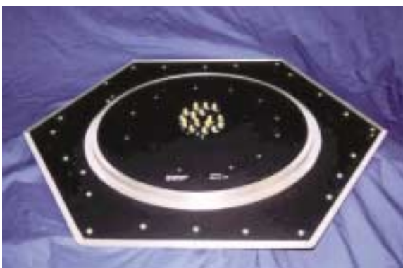
אנטנה לוויינית של Global star המבוססת על מצעי מיקרוגל מתקדמים של Arlon.
