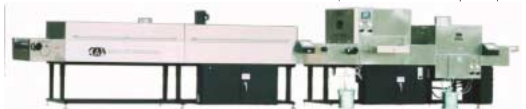
קו דו צדדי ליישום סולדר מסק בריסוס ותנור יבוש כפול, המעגל מקבל את הכסוי בעין אחד
